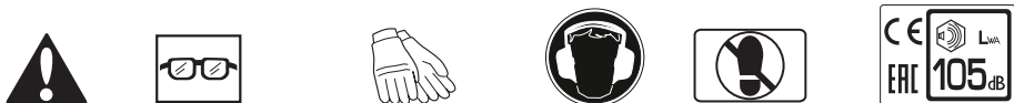
Danger Utilisez des lunettes de protection Utilisez des gants de protection Portez des protège-oreilles Ne vous tenez pas debout ici Émissions sonores dans le milieu environnant conformes à la directive de l'Union Européenne. Les émissions de la machine sont indiquées au chapitre CARACTÉRISTIQUES TECHNIQUES et sur les autocollants.
