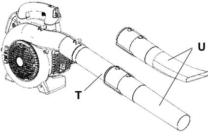
Die Düse (U) wird mit einer Bajonettkupplung am Blasrohr befestigt. Die Luft wird durch das Blasrohr zur Düse geleitet, die die Lufttrittsgeschwindigkeit erhöht und durch ihre Form den Luftstrom für maximale Leistung optimiert. Die Länge des Blasrohrs ist einstellbar; die Düse dazu nach links drehen, um den Bajonettverschluss zu lösen, und dann in die gewünschte Stellung drehen. Die Düse nach rechts drehen, bis sie mit einem Klicken einrastet, um die Düse wieder zu sichern.
