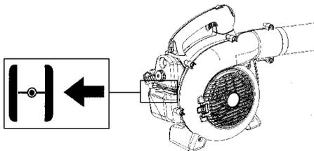
**Start:** Den Gerätekörper mit der linken Hand gegen den Boden drücken (**VORSICHT!** Nicht mit dem Fuß!). Fassen Sie den Starthandgriff fest mit der rechten Hand. NICHT den Gashebel DRÜCKEN. Ziehen Sie langsam das Startseil heraus, bis ein Widerstand fühlbar ist (die Starthaken greifen); dann schnell und kräftig die Reißleine ziehen.
