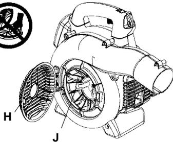
**! WARNUNG!** Der Saughäcksler darf nicht bei offener, beschädigter oder nicht schließbarer Einlassabdeckung gestartet werden. Dies gilt nicht bei angeschlossenem Saugzusatz.
